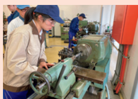
旋盤を使った金属加工
