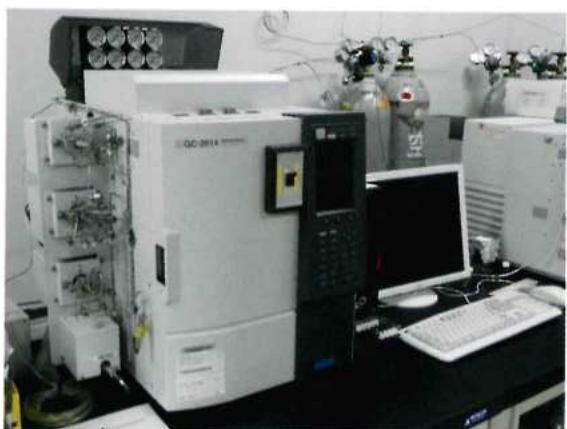
化合物の定性・定量分析に用いる装置です。試料を気化させて成分ごとに分離し、化合物の種類や含有量を決定します。
