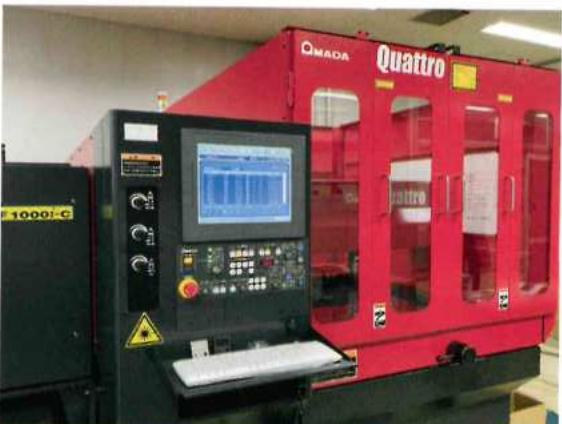
鉄板を切断・加工する機械です。パソコンでレーザーの軌跡をプログラムし、加工機に読み込ませて運転します。
